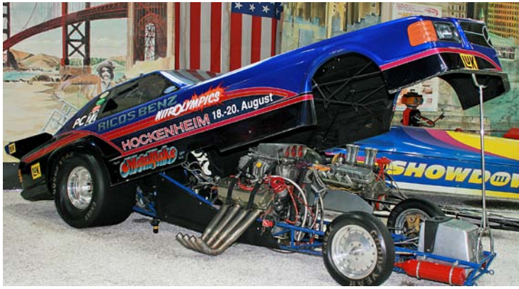
Drag-Racing im Zeichen des Sterns - Mercedes Funny Car mit 2000 PS und einem Toppespeed von 362 km/h über die Viertelmeilen-Distanz links im Museum Sinsheim und rechts auf der Rennstrecke.
